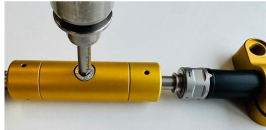
Abbildung 40 Lösen des gelben Rohrs
