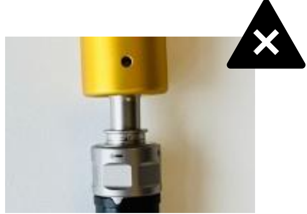
Figuur 6 Onjuiste positie van het metalen duimwiel
