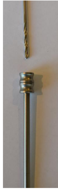
Figuur 20 Plaats de 3.5.mm boor
