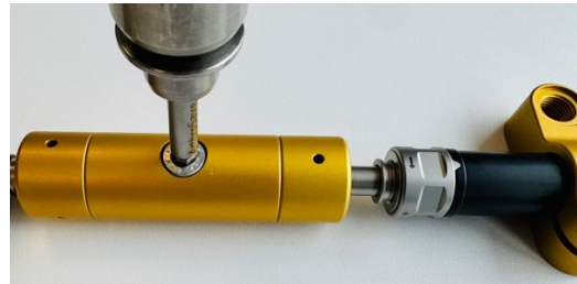
Figuur 40 Losdraaien van de gele buis
