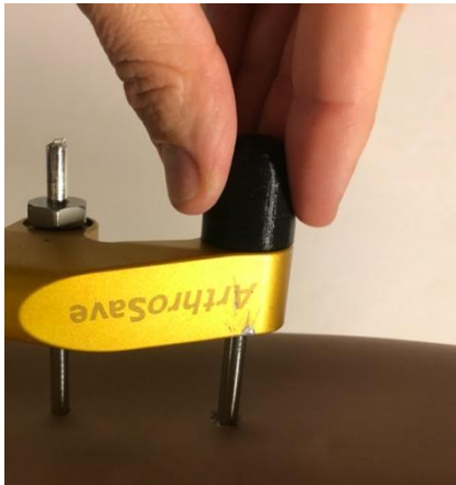
Figuur 52 Plaatsen van de plastic botpenbeschermdoppen over de geknipte botpen.
