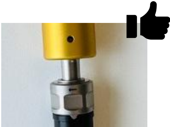
Figuur 5 Juiste positie van het metalen duimwiel
