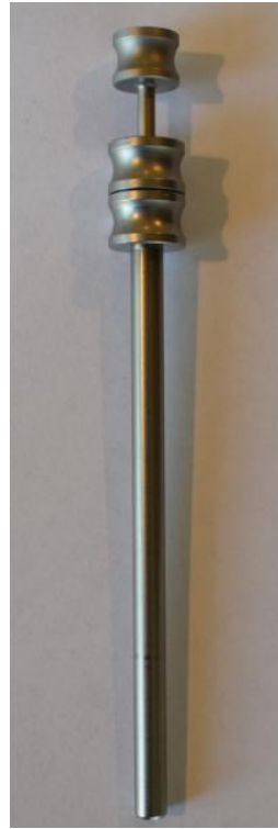
Figuur 19 Gebruik de 3.5mm boorgeleider
