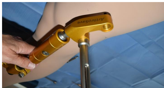
Figura 24. Posizionare il Bullone di bloccaggio per viti con filetto parziale sulla Vite con filetto parziale e stringere con il Limitatore di coppia
