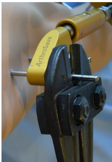
Figura 51. Tagliare la Vite con filetto parziale
