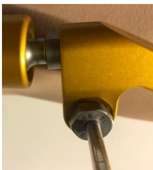
Figura 23. Posizionare il Bullone di bloccaggio per viti con filetto parziale sulla Vite con filetto parziale
