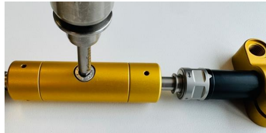
Figura 40. Allentare il tubo giallo
