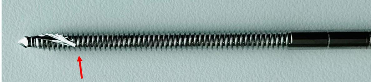
Figure 11 : Filetage complet de la broche de forage (la flèche rouge indique le premier filetage complet)
