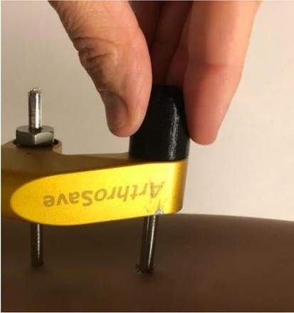
*Figure 52 Placer des capuchons de broche en plastique sur les demi-broches coupées*
