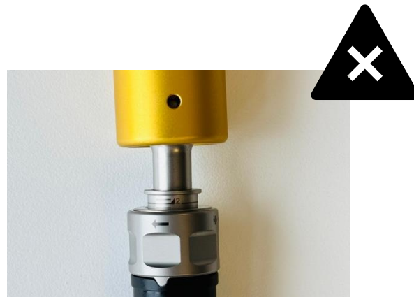
Figura 6 Posición incorrecta del tornillo de palomilla hexagonal metálico
